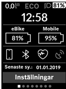
På statusskärmen visas bredvid statusraden även aktuellt klockslag, laddningsnivå för alla batterier på din eBike samt laddningsnivå för din smarttelefon, om den är ansluten via *Bluetooth*®. Under detta visas ev. symboler för aktiverad *Bluetooth*®-funktion eller enheter som är anslutna via *Bluetooth*® (t.ex. en pulsmätare). Dessutom visas
