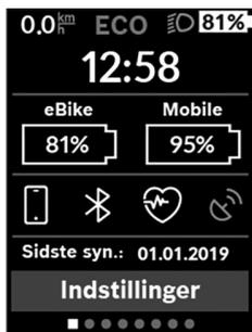
På statusskærmen får du ved siden af statuslinjen vist det aktuelle klokkeslæt, ladetilstanden for alle din eBikes akkuer og ladetilstanden for dit smartphone-batteri, hvis din smartphone er forbundet via *Bluetooth*<sup>®</sup>.
