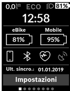
Nella schermata di stato vengono visualizzati, oltre alla barra di stato, l'ora attuale, il livello di carica della batteria dell'eBike e il livello di carica della batteria del vostro smartphone, qualora lo smartphone sia collegato via *Bluetooth*<sup>®</sup>.
