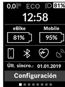
Además de la barra de estado, la pantalla de estado muestra la hora actual, el estado de carga de todos los acumuladores de su eBike y el estado de carga de la batería de su smartphone, en caso de que esté conectado a través de *Bluetooth*<sup>®</sup>.
