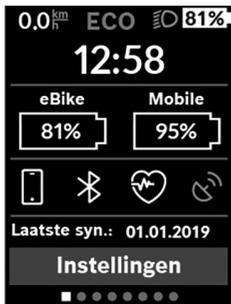
Op het statusscherm krijgt u naast de statusbalk de actuele tijd, de laadtoestand van alle accu's van uw eBike en de laadtoestand van uw smartphone-accu te zien, als de smartphone via *Bluetooth*<sup>®</sup> is verbonden.
