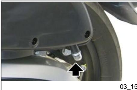
4. Den unteren Teil des Entlüftungsdeckels auf Verunreinigungen überprüfen.
