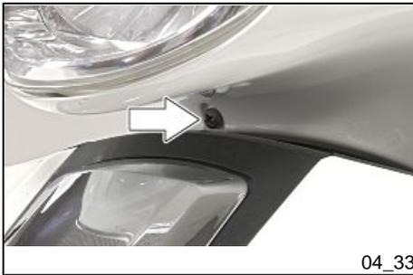
Die vordere Befestigungsschraube der vorderen Lenkerabdeckung abschrauben. Die vordere Abdeckung des Lenkers entfernen.
