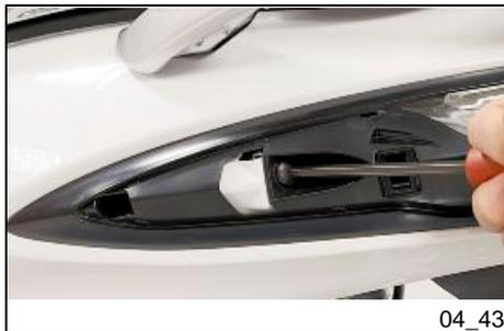
Von beiden Fahrzeugseiten, die seitliche Befestigungsschraube der Rücklichteinheit abschrauben.
