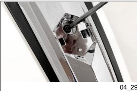
Die Befestigungsschraube des Kühlergrills am Rahmen abschrauben.
