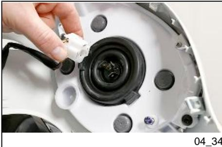
Den Kabelstecker der Lampe der Abblendlichter/Fernlichter trennen.
