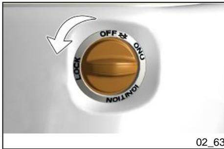
Den Anlasserschalter in die Position «**LOCK**» drehen.
