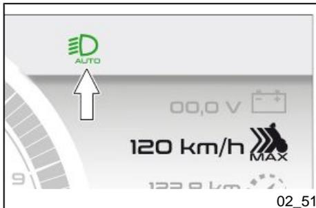
Wenn die Tagesleuchte D.R.L. auf Automatikbetrieb eingestellt ist, leuchtet das entsprechende Symbol in der Digitalanzeige auf.
