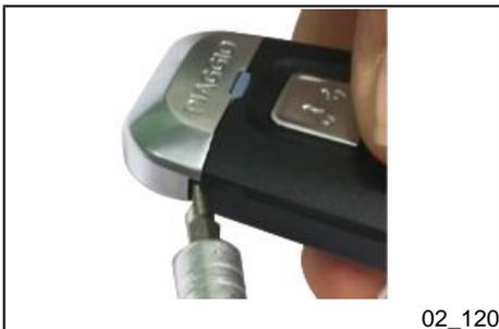
Die beiden Schalenhälften der Fernbedienung trennen, indem man mit einem **Werkzeugkit aus Kunststoff zum Aushebeln** den gesamten Schlitz entlang fährt, damit die Oberfläche nicht zerkratzt wird.
