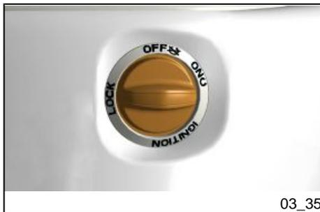
Wird die Feststellbremse in Position «**B**» angezogen und das Zündschloss auf «**LOCK**» gedreht, schaltet sich ein Sicherheitssystem ein, das ein Lösen der Feststellbremse verhindert.
