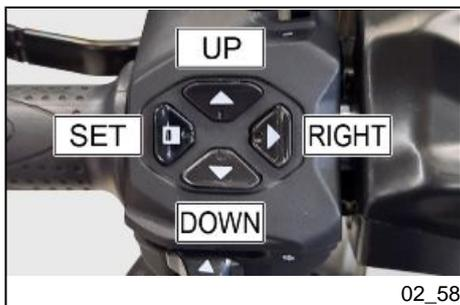
Durch kurzes Drücken der Tasten **"UP"** oder **"DOWN"** kann zwischen den verschiedenen Funktionen geblättert werden.
