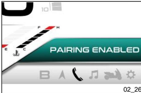
Durch kurzes Drücken der Tasten "**UP**" oder "**DOWN**" das Menü "**Konfiguration**" > "**Konf. Verbindung**" > "**Anfrage zur Verbindung**". aufrufen.
