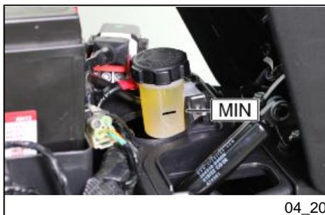
Liegt der Bremsflüssigkeitsstand der Allradbremsanlage unter der Markierung «**MIN**» am Behälter, das Fahrzeug nicht verwenden und eine **autorisierte Vertragswerkstatt** aufsuchen.
