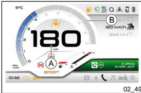
Wenn die Funktion **EINSTELLUNGEN** aufgerufen ist, durch kurzes Drücken der Tasten "UP" oder "DOWN" durchblättern und das Menü "GRAFIK" durch kurzes Drücken der Taste "SET" aufrufen.
