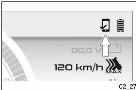
Auf dem Smartphone wird das Gerät "PMP3-XXXX" in der Liste der zugewiesenen Geräte angezeigt. Warten bis das Digitaldisplay das Smartphone automatisch verbindet. **Die Verbindung NICHT über das Telefon erzwingen.**
