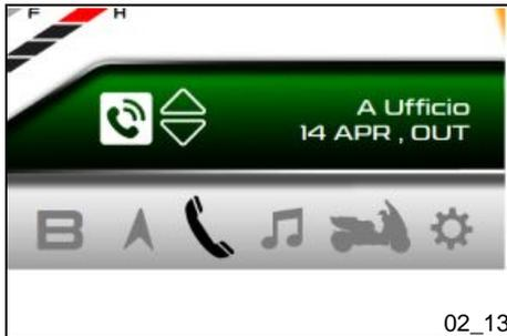
Die Navigation innerhalb des Digitaldisplays erfolgt über die Steuertasten auf der linken Seite des Lenkers.
