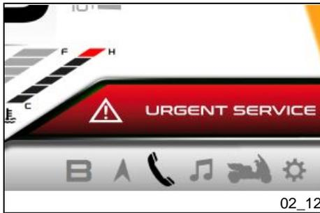
Bei einigen Störungen, die von den Steuergeräten des Fahrzeugs erkannt werden, leuchtet das Digitaldisplay, je nach Ursache mit einem anderen Text an, wobei ein roter Rahmen mit der allgemeinen Alarmleuchte aufleuchtet.
