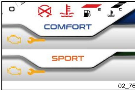
Wenn sich das Fahrzeug im Leerlauf befindet, wird mit dem Anlasserschalter der ASR-Systemtyp ausgewählt.
