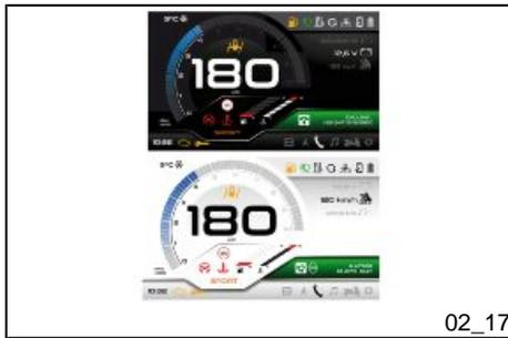
Es ist jedoch auch möglich, die Farbe der Hintergrundbeleuchtung manuell zu ändern, indem die Funktion **EINSTELLUNGEN** aufgerufen wird und, durch kurzes Drücken der Tasten **"UP"** oder **"DOWN"** durch sie geblättert wird und das Menü **"HINTERGRUNDBELEUCHTUNG"** durch kurzes Drücken der Taste **"SET"** aufrufen.
