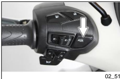
3. **Das ASR-System deaktivieren**, indem die entsprechende Taste mindestens 1 Sekunde lang mit laufendem Motor gedrückt wird. Das Symbol «ASR OFF» **beginnt, fest zu leuchten**, anfänglich war es ausgeschaltet, da das ASR-System bereits zuvor kalibriert worden war.
