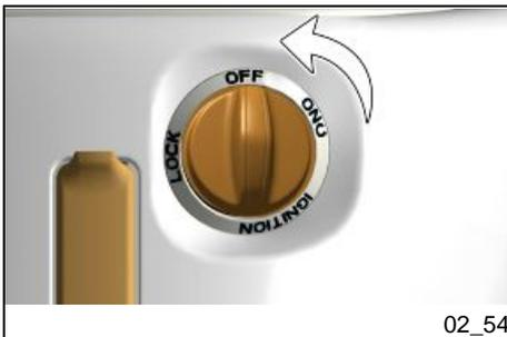
7. Das Fahrzeug anhalten und **den Motor abschalten,** indem das Zündschloss in die Position «OFF», gedreht wird.
