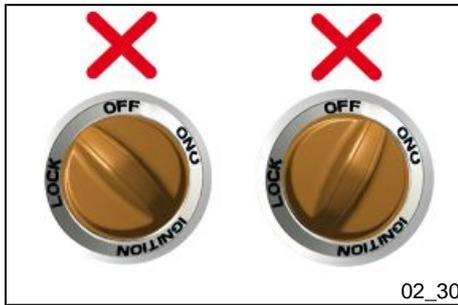
Achten Sie bei der Betätigung des Schalters auf die korrekte Drehung in die Positionen «**LOCK**» und «**OFF**»: Der Drehknopf muss bei «**LOCK**» am Anschlagende losgelassen oder bei «**OFF**» perfekt ausgerichtet sein.
