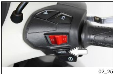
**Bei** Fahrzeugen, die mit einem Heizungszusatzsteuergerät (optional) ausgestattet sind, steuert die **MODE**-Taste am Lenker die Heizungsstufen und wiederholt nicht mehr die Funktionen der **MODE**-Taste der Instrumentengruppe.
