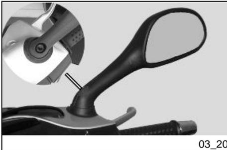
Die Rückspiegel müssen so eingestellt werden, dass der Arm rechtwinklig zur Fahr- richtung des Fahrzeugs steht.
