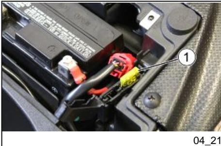
**Sicherungen (04\_21, 04\_22)****HAUPTSICHERUNG**
