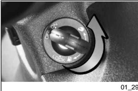
Ist die Fahrzeugbatterie entladen, das Zündschloss gleichzeitig drücken und drehen (siehe Abbildung) und das hintere Staufach öffnen.
