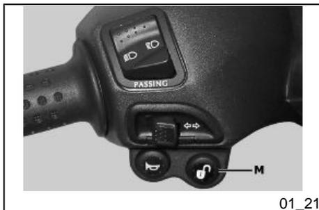
**DAS NICHTAUSSCHALTEN DER HELMFACHBELEUCHTUNG WIRD DURCH EINE ENTSPRECHENDE KONTROLLLAMPE AN DER INSTRUMENTENEINHEIT ANGEZEIGT.**
