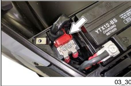
Am vom auf dem Foto gezeigten Verbinder geschützten Anlasserrelais befindet sich die Hauptsicherung «13».
