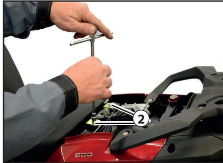
2. Schrauben Sie 2 beiden Schrauben.
