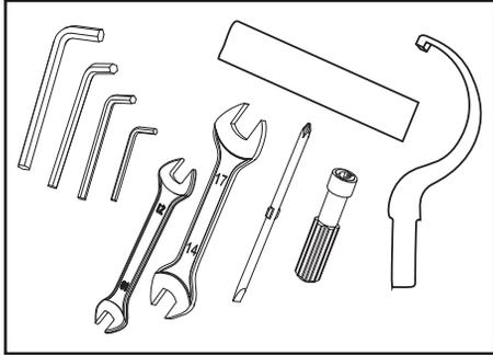
Zusammen mit dem Fahrzeug wird eine Werkzeugtasche geliefert. Das Bordwerkzeug befindet sich unter dem Beifahrersitz.
