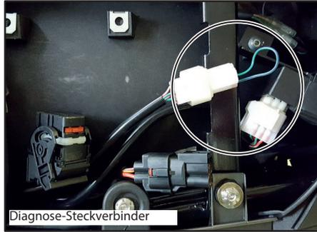
Der Diagnose-Steckverbinder befindet sich an der abgebildeten Position.
