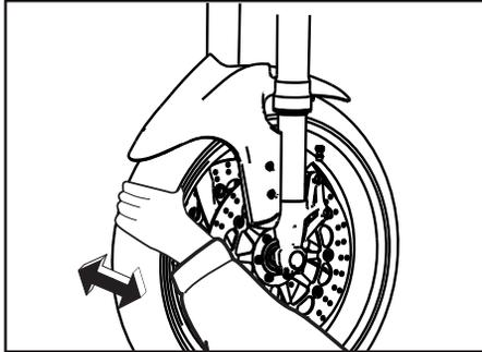
Die Vorder- und Hinterradlager müssen in den empfohlenen Abständen gemäß Wartungs- und Schmiertabelle geprüft werden.
