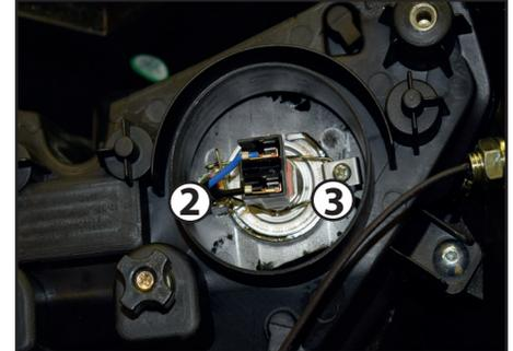
2. Ziehen Sie die Stecker der Lampe zu ersetzen.
