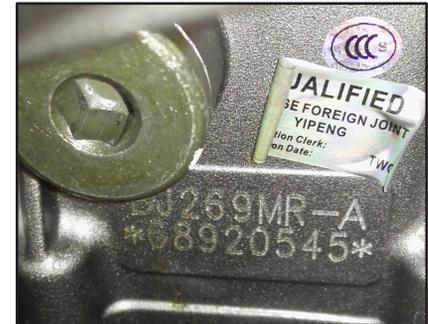
Diese Nummer ist am Gehäuse des Motors auf der rechten Seite des Fahrers eingepreßt und gibt die Seriennummer des Motors an.
