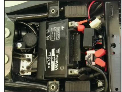
Dieses Modell ist mit einer VRLA-Batterie (Valve Regulated Lead Acid) ausgestattet. Die Kontrolle des Säurestands und das Auffüllen von destilliertem Wasser entfallen deshalb. Die Anschlüsse der Batterie kabel müssen jedoch kontrolliert und ggf. festgezogen werden.
