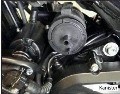
Dieses Modell ist mit einem Kanister ausgestattet, um zu verhindern, dass Kraftstoffdämpfe in die Atmosphäre gelangen. Vor Inbetriebnahme des Fahrzeugs sicherstellen, dass Folgendes kontrolliert wird:
