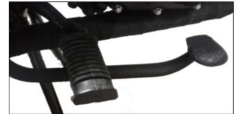
Die Hinterradbremse wird durch das Treten auf das Hinterradbremspedal aktiviert (wie im Bild zu sehen); bei der Bedienung der Hinterradbremse leuchtet das Bremslicht.
