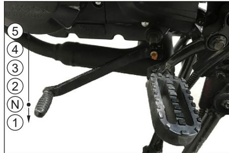
Dieses Fahrzeug verfügt über ein 5-Gang-Getriebe (nicht-zyklisch). Der Leerlauf befindet sich zwischen dem ersten und zweiten Gang. Wenn sich das Getriebe im Leerlauf befindet, drücken Sie den Schalthebel nach unten, um in den ersten Gang zu schalten. Ziehen Sie den Hebel nach oben, um in den nächsten Gang zu schalten. Um nach unten zu schalten, drücken Sie den Hebel wieder nach unten. Aufgrund des Schaltmechanismus können nicht gleichzeitig mehrere Gänge hinauf- oder hinuntergeschaltet werden.
