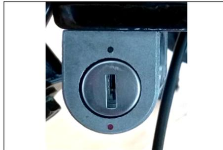
Stecken Sie den Schlüssel in das Lenkradschloss. Dieses befindet sich an der rechten unteren Seite des Steuerrohres. Drehen Sie den Lenker bis auf Anschlag nach links und den Schlüs-
