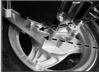
Das Fahrzeug benutzt Getriebeöl des Typs **SAE 80W/90** (0,11 l)
