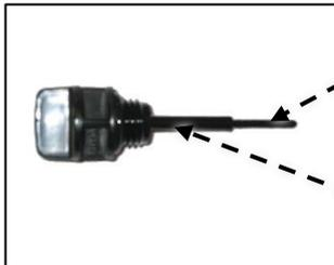
2. Wenn die Motorölmenge sich der unteren Grenze ② nähert, fügen Sie geeignetes Motoröl hinzu, wobei darauf zu achten ist, dass der obere Grenzwert ③ nicht überschritten werden muss. Dann den Ölstab zurück fest einschrauben. Überprüfen Sie abschließend, ob Öl austritt.
