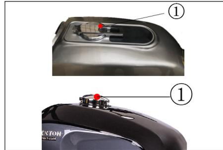
Drehen Sie die Schlossabdeckung des Tanks beiseite und stecken Sie den Schlüssel in das Schloss (1). Öffnen Sie den Kraftstofftank durch Drehen des Schlüssels im Uhrzeigersinn. Um den Tankdeckel zu schließen, richten Sie den Führungsstift des Tankdeckels aus, drücken Sie den Schlüssel hinein und drehen Sie diesen gegen den Uhrzeigersinn. Abschließend schieben Sie die Schlossabdeckung des Tanks darüber.
