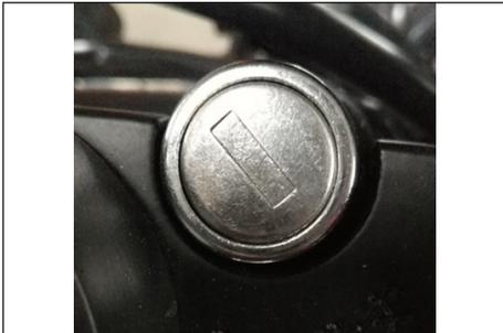
Bei Drehung des Schlüssels im Uhrzeigersinn wird die Zündung eingeschaltet; der Motor kann gestartet werden. Ist die Zündung eingeschaltet, kann der Schlüssel nicht abgezogen werden. Bei Drehung des Schlüssels gegen den Uhrzeigersinn wird die Zündung ausgeschaltet der Schlüssel kann abgezogen werden.
