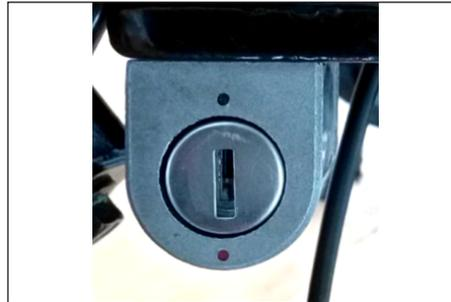
Stecken Sie den Schlüssel in das Lenkenschloss. Dieses befindet sich an der rechten unteren Seite des Steuerrohres. Drehen Sie den Lenker bis auf Anschlag nach links und den Schlüs-
