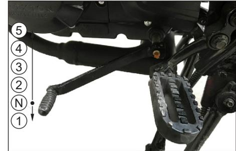
Dieses Fahrzeug verfügt über ein 5-Gang-Getriebe (nicht-zyklisch). Der Leerlauf befindet sich zwischen dem ersten und zweiten Gang. Wenn sich das Getriebe im Leerlauf befindet, drücken Sie den Schalthebel nach unten, um in den ersten Gang zu schalten. Ziehen Sie den Hebel nach oben, um in den nächsten Gang zu schalten. Um nach unten zu schalten, drücken Sie den Hebel wieder nach unten. Aufgrund des Schaltmechanismus können nicht gleichzeitig mehrere Gänge hinauf- oder hinuntergeschaltet werden.
