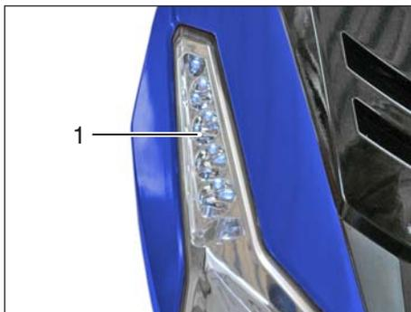
Das Standlicht (1) ist ohne auswechselbare Glühlampen (Diodenlicht) ausgestattet. Funktioniert das Standlicht nicht, ist zunächst zu überprüfen, ob eine Kabelverbindung unterbrochen ist.
