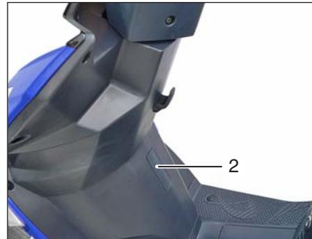
Die Fahrgestellnummer des Motorrollers befindet sich am Rahmen hinter der vorderen Abdeckung (2).
