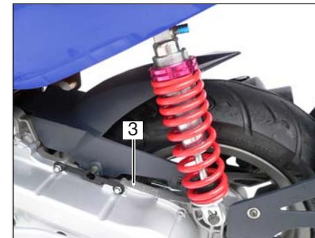
Die Motornummer (3) des Motorrollers befindet sich auf der linken Fahrzeugseite.
