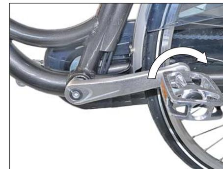
Pedal für Hinterradbremse mit Rücktrittbremse
