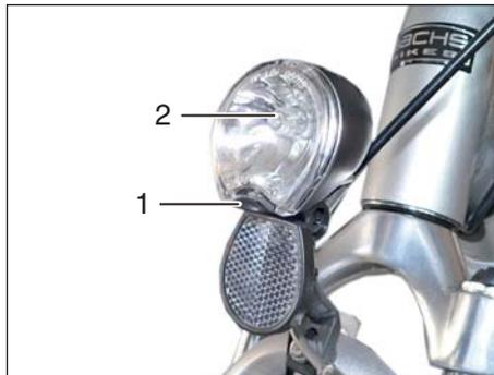
Der Scheinwerfer muss so nach vorn geneigt sein, dass die Mitte des Lichtkegels nach 5 m nur noch halb so hoch liegt, wie beim Austritt aus dem Scheinwerfer. In der Praxis bedeutet dies, dass nur eine Fahrbahnausleuchtung von höchstens 10 m erlaubt ist.
