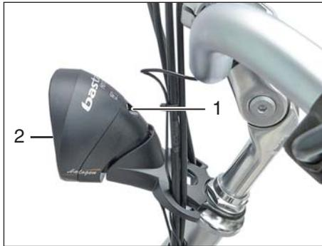
Der Scheinwerfer muss so nach vorn geneigt sein, dass die Mitte des Lichtkegels nach 5 m nur noch halb so hoch liegt, wie beim Austritt aus dem Scheinwerfer. In der Praxis bedeutet dies, dass nur ein Ausleuchten der Fahrbahn von höchstens 10 m erlaubt ist.
