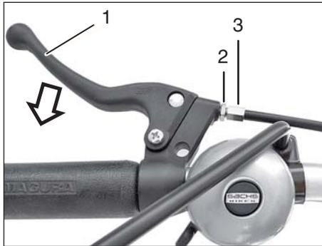
Handbremshebel (1) für Hinterradbremse ohne Rücktrittbremse
