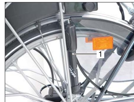
Die Luftpumpe (1) ist seitlich am Gepäckträger angebracht.
