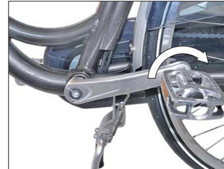
Pedal für Hinterradbremse mit Rücktrittbremse
