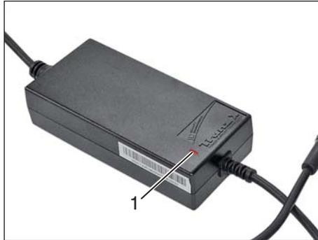
Die LED (Leuchtdiode 1) am Ladegerät hält Sie über den Betriebszustand ständig auf dem laufenden. Sie werden über Status und Ladevorgang des Akkus auf einen Blick informiert.
