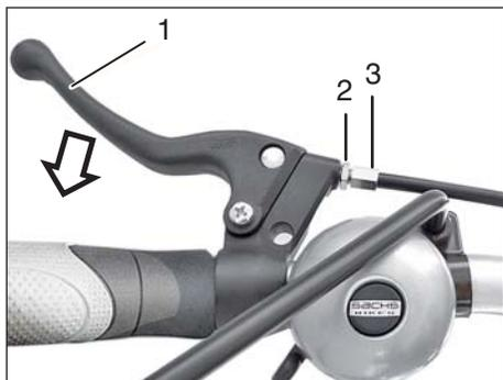
Handbremshebel (1) für Hinterradbremse ohne Rücktrittbremse
