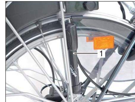
Die Luftpumpe (1) ist seitlich am Gepäckträger angebracht.
