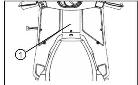
Die Batterieabdeckung (1) befindet sich im Fußraum des Fahrzeuges.
