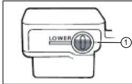
• Ein geringer Füllstand kann auch auf verschlissene Bremsbeläge und/oder eine Undichtigkeit im Bremssystem hinweisen.
