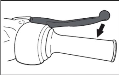
Der Bremshebel für die Hinterradbremse befindet sich am Lenker links. Zum Bremsen ziehen Sie den Hebel in Richtung Lenker.
