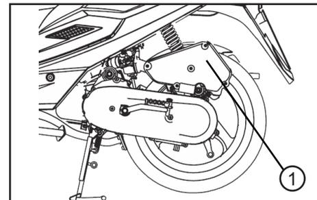
Der Luftfilter muss entsprechend der Wartungstabelle getauscht werden. Wechseln Sie den Luftfilter häufiger, wenn Sie in ungewöhnlich staubiger oder feuchter Umgebung fahren.
