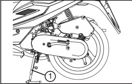
Der Hauptständer (1) befindet sich auf der Fahrzeugunterseite. Klappen Sie den Seitenständer mit dem Fuß aus und stellen Sie das Fahrzeug aufrecht ab.
