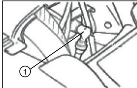
2. Drehen Sie die Zündkerze mit dem Zündkerzenschlüssel (2) heraus. Der Zündkerzenschlüssel befindet sich beim Boardwerkzeug.
