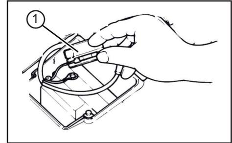
Der Sicherungshalter (1) befindet sich hinter der Batterieabdeckung.
