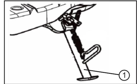
Der Seitenständer (1) befindet sich auf der linken Fahrzeugseite. Klappen Sie den Seitenständer mit dem Fuß aus und stellen Sie das Fahrzeug aufrecht ab.
