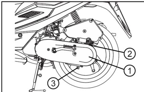
5. Setzen Sie die Getriebeöl-Ablassschraube zurück und ziehen Sie sie mit dem korrekten Drehmoment an.
