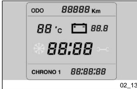
Mit kurzem Druck auf die Taste SET können die Seiten mit den Messwerten durchlaufen werden, bei langem Druck stellt sich das Display auf das Menü CHRONOMETER zurück.
