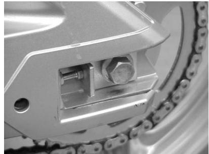
Die Antriebskette spannen oder entlasten Sie, indem Sie die Hinterachsmuttern lösen, und die Kettenspanner an der Hinterachse drehen. Die Kette sollte sich in belastetem Zustand ca. 35-40mm durchdrücken lassen. Von Zeit zu Zeit sollte die Kette auch gereinigt werden. Dies tun Sie am besten mit einer Bürste, und einem speziellen Kettenreinigungsmittel, welches Sie im Fachhandel erhalten.
