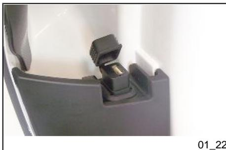
Die USB-Buchse wird aktiviert, sobald der Schlüssel auf «ON» gedreht wird.
