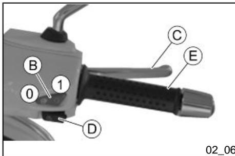
5. Den Anlasserschalter «D» drücken, nachdem der Vorderradbremshebel «C» oder der Hinterradbremshebel gezogen wurde.
