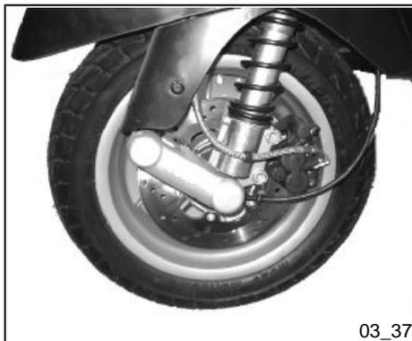
HEN, DAMIT SICH DIE BREMSKOLBEN SOWIE DER BREMSHEBELHUB IN DER RICHTIGEN POSITION SETZEN KÖNNEN.
