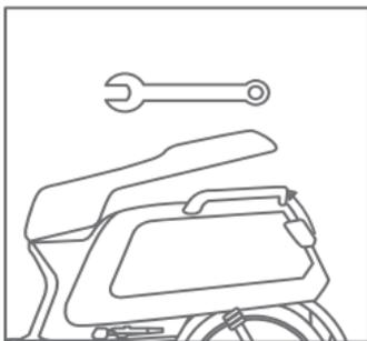
Stecken Sie den Schlüssel in das Schlüsselloch in der hinteren Ablage und drehen Sie ihn, um das Batteriefach zu öffnen. Nehmen Sie das Ladegerät und die Rückspiegel heraus.
