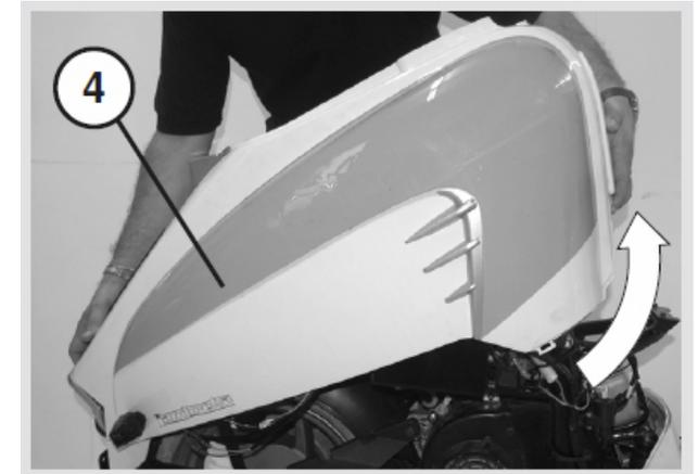
Entfernen Sie die Verkleidung (4), indem Sie sie nach vorn schieben und drehen, während Sie die Vorderseite wie in der Abbildung gezeigt in der Bewegung anheben.
