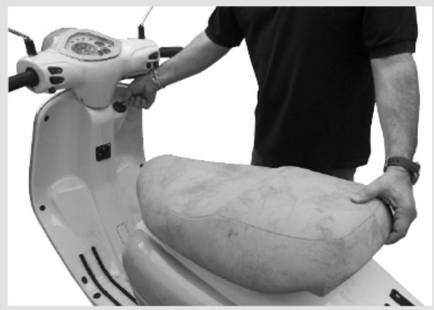
Um auf den Motor und die elektrischen Komponenten zuzugreifen, ist es notwendig, die hintere Karosserie des Fahrzeugs zu entfernen.
